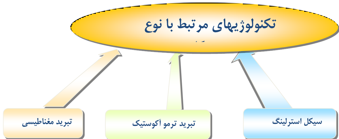
شکل (۶-۳) تکنولوژی های مرتبط با نوع سیکل تبرید یخچالها و فریزرها
